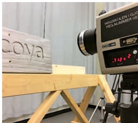
Måling av luminanskontrast på nye og eldre skilt i våt og tørr tilstand. Begge foto: Universell Utforming AS
